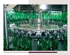
Этот метод обеспечивает качественное ополаскивание внутренней поверхности бутылки и полное вытекание ополаскивающего раствора, т.к. за время прохождения бутылки в таком положении ополаскивающая жидкость успевает стечь и далее бутылка, переворачиваясь в исходное положение, подается на конвейер. В зависимости от типа бутылок, время ополаскивания и стекания жидкости из бутылки можно редуцировать, используя электрический инвертор
