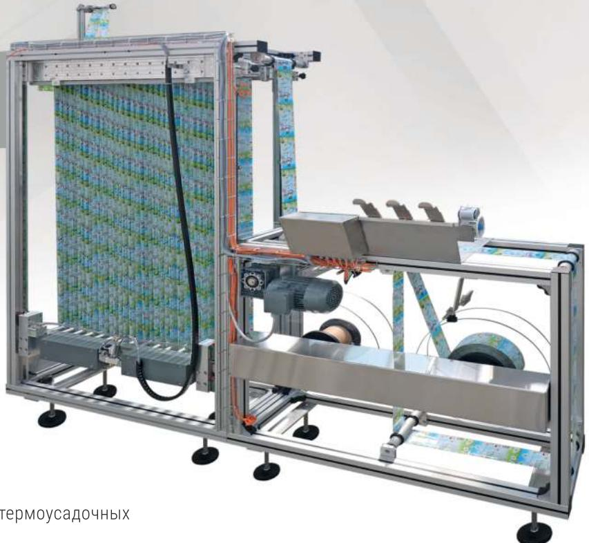
Машины для апликации полных или частичных термоусадочных (sleeve) этикеток.
